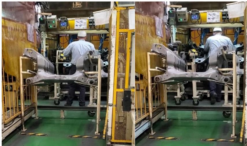
*Figura 17 Operador colocando pieza en máquina ensambladora desde el carro trasportador.*
